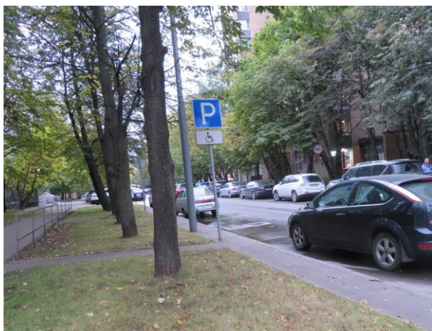
Рисунок 98 — Недопустимое расположение парковки для транспорта инвалидов вдоль газона
