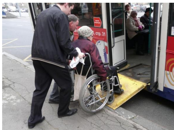
Рисунок 108 — Безопасный уклон рампы автобуса обеспечивает повышенный уровень посадочной площадки
