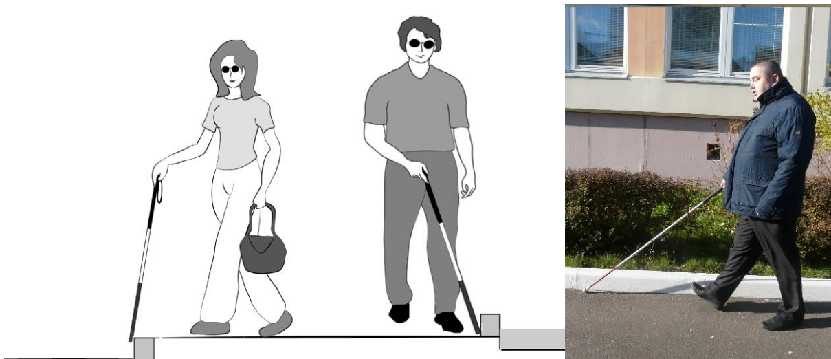
Рисунок 22 — Бортовые камни, как направляющие для людей с белой тростью
