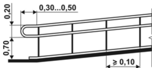
Рисунок 85 — Горизонтальные завершения поручней на лестничных сходах
