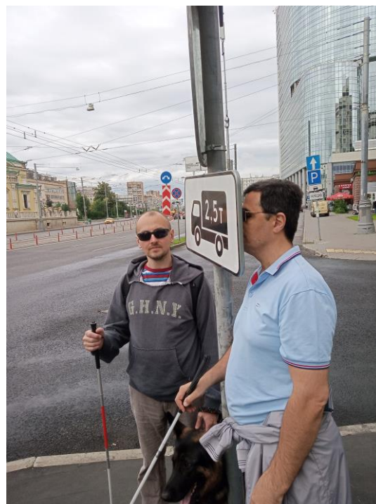
Рисунок 101 — Выступающее препятствие на уровне лица в зоне пешеходного движения
